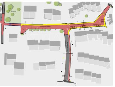
senkt, bis er auf die neue Fahrbahnoberfläche trifft. An einer bestimmten Stelle der neuen Fahrbahn befinden sich zwei gepflasterte Einfahrten, die in ihrem jetzigen Zustand erhalten bleiben müssen. Der neue Belag wird daher vorübergehend unterbrochen und unmittelbar nach den Eingängen wieder aufgenommen. Auf der gegenüberliegenden Seite wird ein ca. 30 m langer Abschnitt des Randsteines, entlang der Einfahrt, durch einen leicht rosafarbenen Granitbordstein ersetzt.
